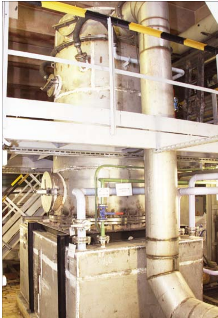
Новый участок десульфатизации медэлектrolитных сплавов.
