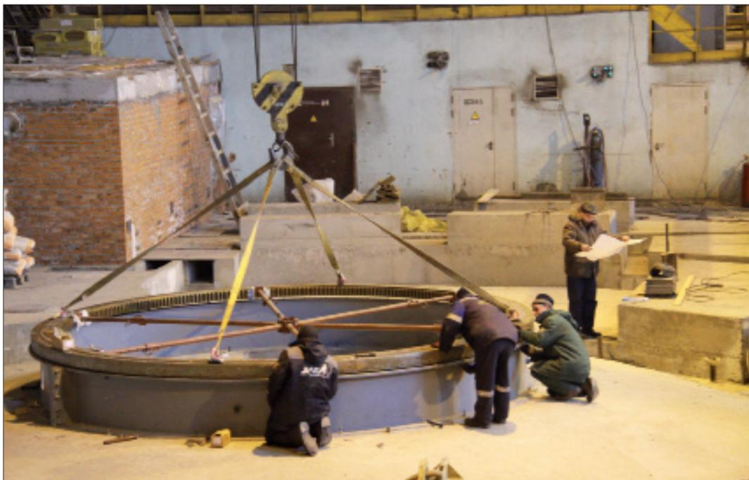
Так монтируется на опорное кольцо разливочной машины пятиметровый подшипник.
