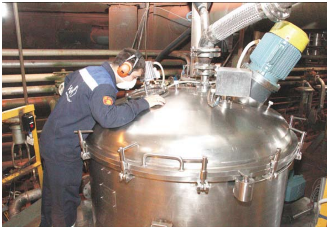
Аппаратчик контролирует работу центрифуги для промывки и стабилизации медных порошков.
