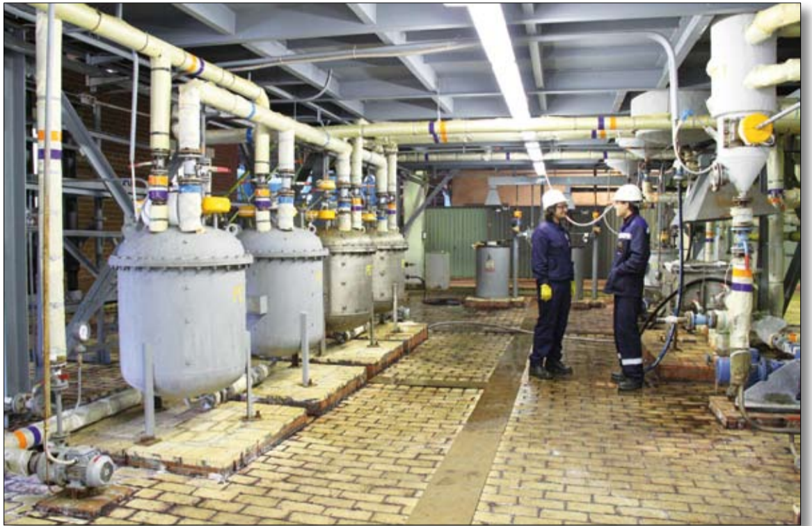
Укрупнённая гидрометаллургическая установка стала серьёзным подспорьем в работе учёных ОАО «Уралэлектромедь»: с прошлого года этот объект, созданный совместными усилиями ОАО «Уралэлектромедь» и УрФУ имени первого Президента России Б. Н. Ельцина, служит на нашем предприятии прикладной науке. Установка позволяет воссоздать условия, которые существуют в реальном производстве, и проводить с меньшими материальными и временными затратами испытания новых технологий.
